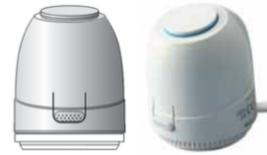
**Термоэлектрическая головка 24 V, М 30 x 1,5. Арт. 180040012.** Устанавливается на вентили термостатические арт. 500440 или 500501. Без подачи сигнала находится в открытом состоянии.
